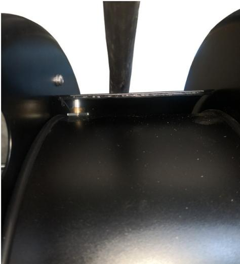
Microrruptor abierto, se ha llegado al final del cable del enrollador.
